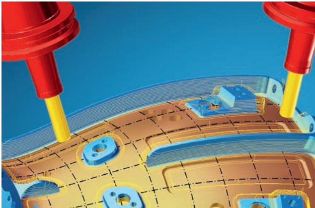
Acabado equidistante de piezas de 5 ejes Fresado con fresa madre de 5 ejes Repasado de mecanizado de 5 ejes
