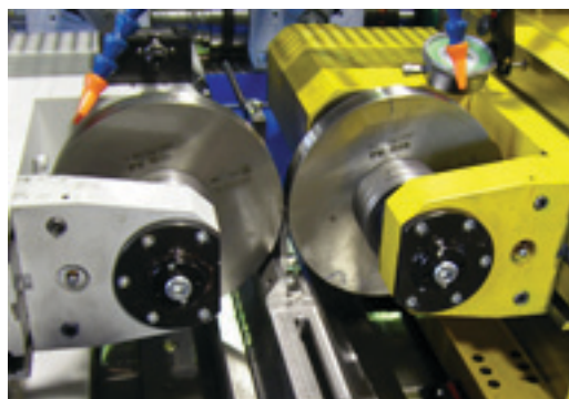
Proceso de roscado por laminación
