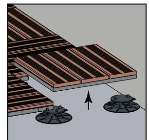
El montaje sobre plots permite mover una baldosa fácilmente
