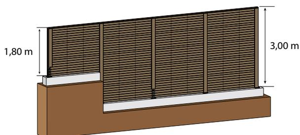
Poste sobre pie de poste para una altura de 0,6 a 3 m (puntales obligatorios a partir de 2,40 m en función de las condiciones climáticas).
