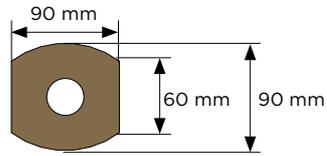
Poste cepillado y fabricado según el diseño de los paneles Samba. Perforado para colocarse sobre pletina.
