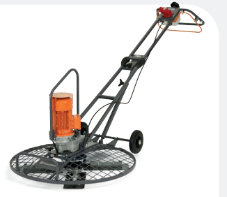
ELÉCTRICO HUSQVARNA BG COMBI 1,8–2,4 kW, 1020–850 mm, 88–86 kg.
