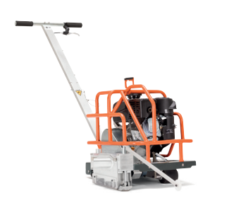
GASOLINA HUSQVARNA SOFF-CUT 150 Disco de diamante máx. 150 mm, profundidad de corte máx. 30 mm, 40 kg, 4,0 kW*.
