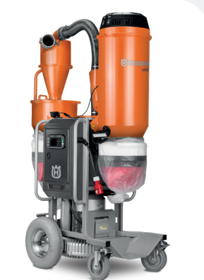
ELÉCTRICO HUSQVARNA HTC D60 5,5 kW, 230-480 V, 15 A, 530 m³/h, 179 kg.
