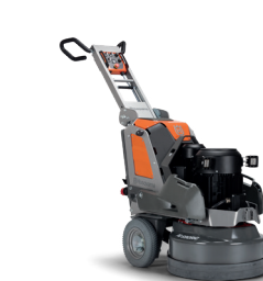
ELÉCTRICO HUSQVARNA PG 690 RC 12,5 kW, 380-415 V, trifásico, ancho de pulido 640 mm, disco de amolado 3 x 270 mm, 598 kg.
