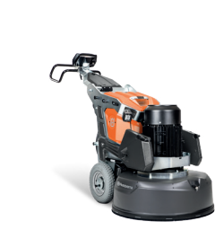
ELÉCTRICO HUSQVARNA HTC X8 / HTC RX8 12/15 kW, 380/415 V, trifásico, ancho de pulido 800 mm, disco de amolado 3 x 270 / 4 x 270 mm, 499/574 kg.
