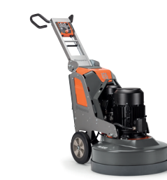
ELÉCTRICO HUSQVARNA PG 830 16,5 kW, 380-415 V, trifásico, ancho de pulido 800 mm, disco de amolado 3 x 270 mm, 556 kg.
