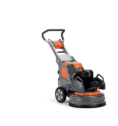
ELÉCTRICO HUSQVARNA PG 540 4,0/2,2 kW, 400/220 V, trifásico/monofásico, ancho de pulido 515 mm, disco de amolado 3 x 230 mm, 178/169 kg.
