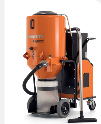
ELÉCTRICO HUSQVARNA T 10000 11 kW, 380-415 V, 32 A, 900 m³/h, 336 kg.
