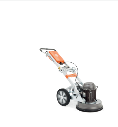
ELÉCTRICO HUSQVARNA PG 400 4 kW, 400 V, trifásico, ancho de pulido 400 mm, 115 kg.
