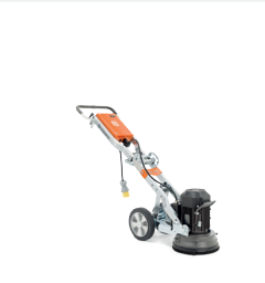
ELÉCTRICO HUSQVARNA PG 280 3/2,2 kW, 400/220 V, trifásico/monofásico, ancho de pulido 280 mm, 70 kg.
