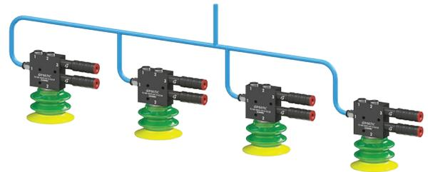
Un sistema centralizado se caracteriza por una bomba para vacío conectada a varias ventosas. A menudo se utiliza para manipular materiales estancos como la chapa o el vidrio.
