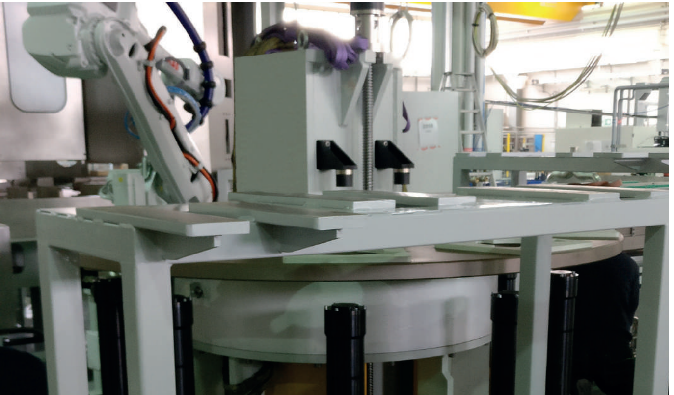
TIG 1200 HD - Automatización del proceso de endurecimiento de rodamientos por inducción
