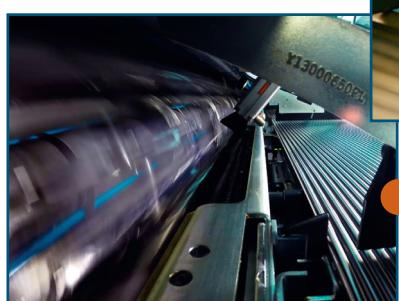
El canal de guiado se cierra perfectamente sobre el diámetro de la barra en toda su longitud. La lubrificación en su interior garantiza un soporte hidrostático de la misma, consintiendo así que el torno alcance una velocidad de rotación de hasta **10.000 rpm** en ausencia de vibraciones
