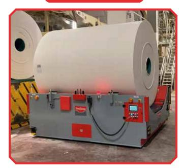
AGV para transporte de bobinas
