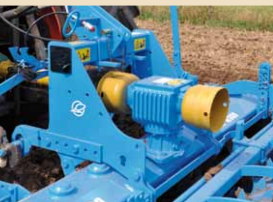
Transmisión simple mediante la caja de cambios con cambio de marchas
