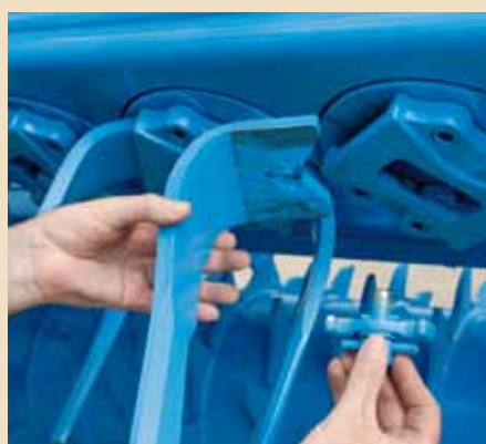
Sustitución de una cuchilla de cambio rápido
