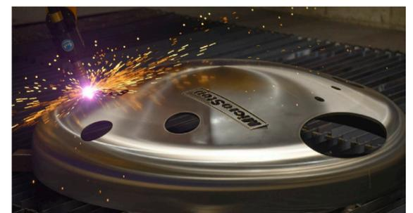
entregada en 2021 les permite cortar planchas de 7,5 x 4 m junto con cúpulas de hasta  $\varnothing$  3.000 mm en dos zonas de trabajo separadas.
