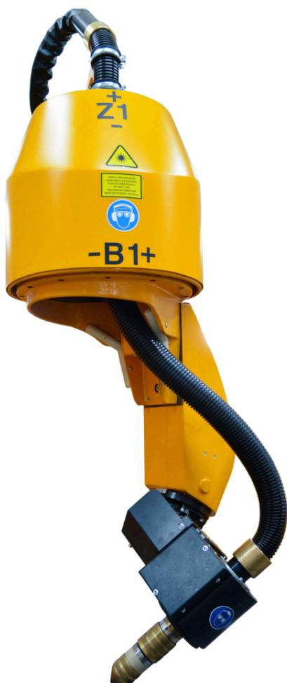
El cabezal de bisel giratorio de 5 ejes con rotación sin fin permite el corte en bisel por plasma de chapas, tuberías, perfiles y fondos de hasta  $52^\circ$ . El innovador soporte de antorcha ITH incluye sensores para la detección de desplazamiento de antorcha, IHS y calibración automática.
