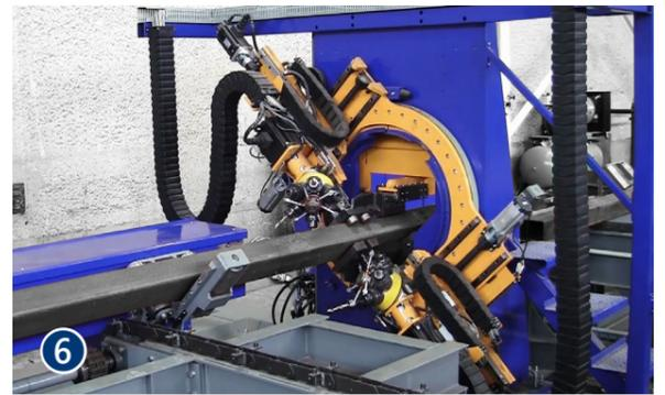
La línea de taladrado de perfiles DS-B permite taladrar, roscar y marcar simultáneamente secciones huecas rectangulares de hasta 12 m de longitud y 300 mm de anchura.
