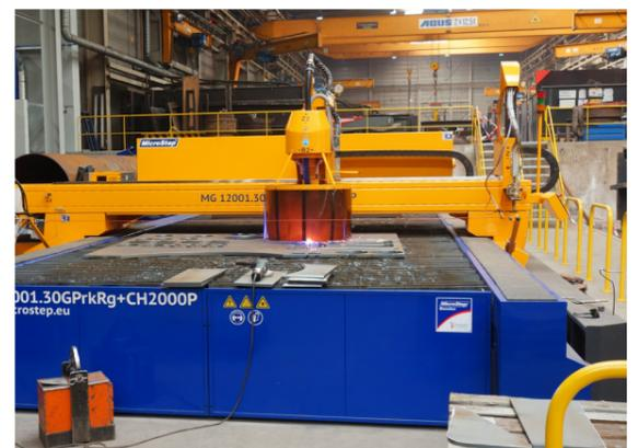
MicroStep suministró la solución de corte completa: con una gran zona de corte de 12 x 3 m para chapas de hasta 150 mm de grosor y una zona para cortar tubos con un robot situado en el lado exterior de las guías de la máquina, ésta es capaz de procesar tubos de hasta Ø 2000 mm y espesor de pared de 80 mm.
