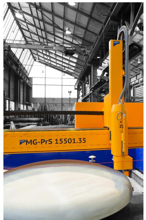
La máxima precisión en el corte de cúpulas es posible gracias a la tecnología mScan de MicroStep. En el proceso, un escáner láser integrado en el pórtico determina de antemano la geometría 3D de la superficie de la pieza.
