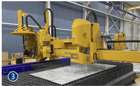
Una máquina multifuncional con taladrado de hasta  $\varnothing 40$  mm (+ roscado y avellanado), marcado por chorro de tinta y un cabezal biselador de plasma con un ángulo de inclinación de hasta  $120^\circ$  y rotación sin fin para el corte de chapas, vigas de tubo y cúpulas..
