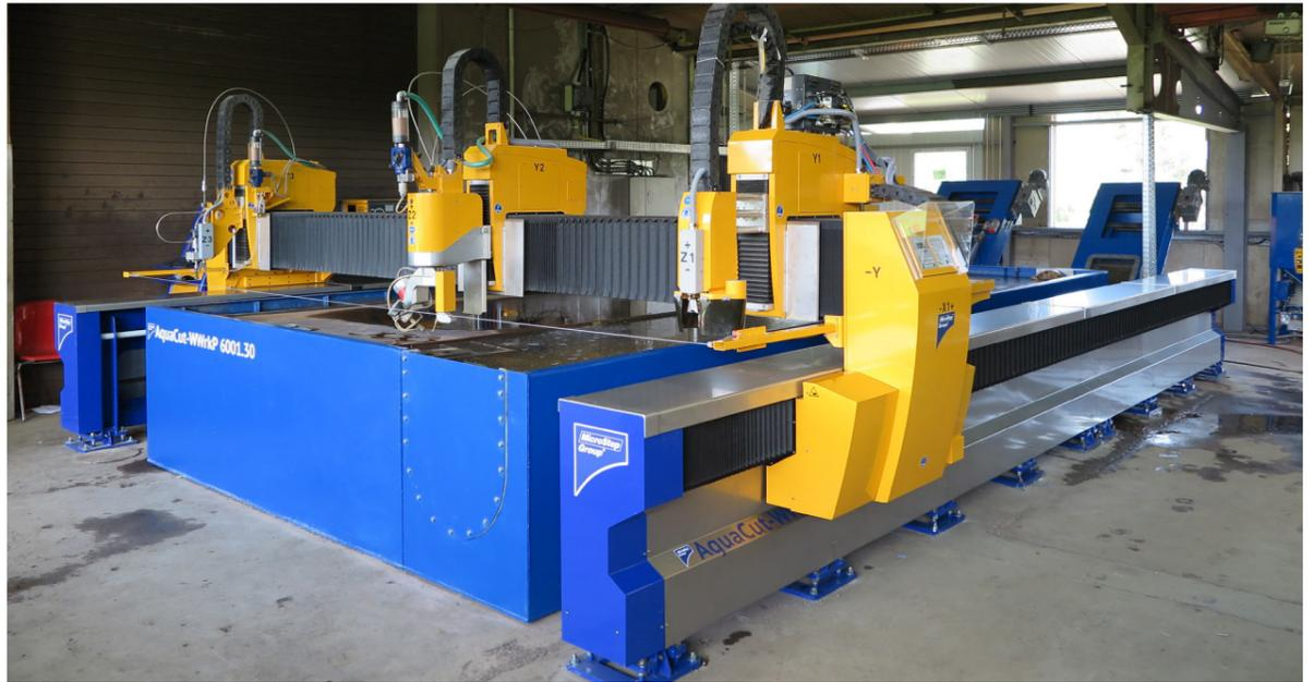
la solución con dos máquinas de corte que utilizaban tecnologías diferentes dejó de ser adecuada porque el funcionamiento y la carga llevaban demasiado tiempo y limitaban la producción. Por ello, Striegel consideró varias ofertas de nuevos equipos y finalmente decidió invertir en una máquina combinada de corte por plasma y chorro de agua CNC de MicroStep. "Tomé esa decisión porque tenía una buena experiencia con MicroStep".
