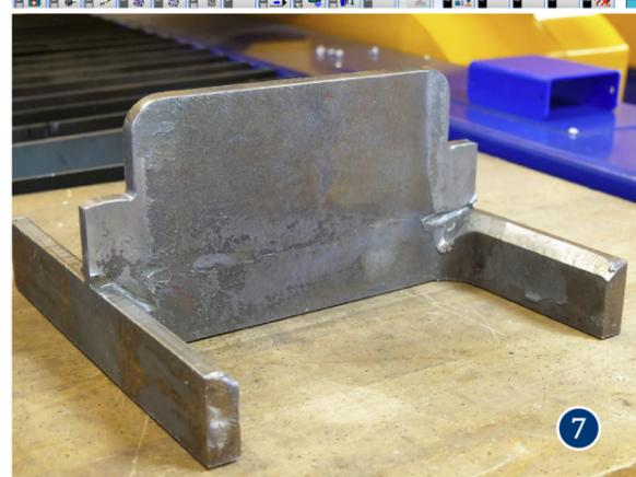
Escaneo y corte del haz en U
