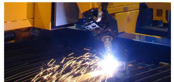
Con la tecnología de biselado de MicroStep, se pueden añadir cortes en V, en Y y (en determinadas condiciones) también en X y en K a piezas ya precortadas.
