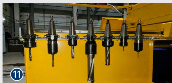
hasta  $\varnothing 20$  mm, roscar hasta M16 y avellanar. Para las máquinas MSF Max con mesas de aspiración estándar (sin cambiadores de palets) hay disponible una broca más potente de hasta  $\varnothing 30$  mm.
