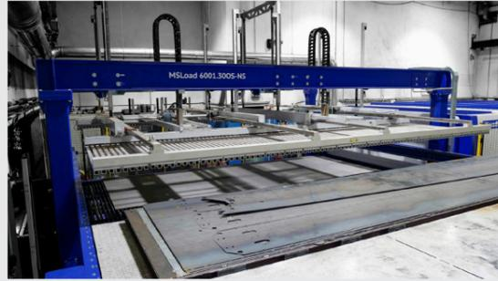
Zona de descarga de la paleta intermedia con sistema MSLoad, con una pila de pedidos descargados en la parte delantera.
