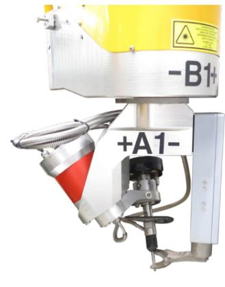
El cabezal biselado giratorio de 5 ejes para chorro de agua permite el corte en bisel de todo tipo de materiales hasta  $45^\circ$ . La compensación adaptativa de la forma cónica (ABC) y la detección periódica de altura (PHS) se incluyen de forma predeterminada.
