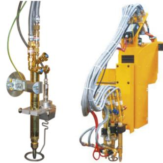
Los cabezales de oxicorte con posibilidad de inclinación manual hasta  $\pm 45^\circ$  con consola de gas completamente automática y parámetros preestablecidos garantiza una calidad estable de cortes y la mejor eficiencia. La versión multi antorcha permite corte de franjas con un ancho de  $\geq 70$  mm.
