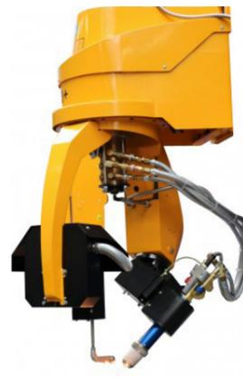
El cabezal biselado giratorio de 5 ejes con rotación sin fin permite el corte biselado por oxicorte de chapas, tuberías y perfiles de hasta  $65^\circ$ . El innovador soporte de antorcha ITH incluye sensores para la detección de desplazamiento de antorcha, IHS y calibración automática.
