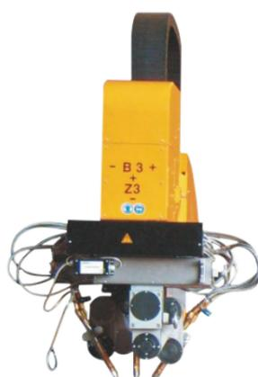
La antorcha de oxicorte triple con consola de gas completamente automática permite el corte en bisel de cortes en V, X, Y y K con 3 antorchas dentro del rango de bisel de  $20^\circ$  a  $50^\circ$ . El ángulo de inclinación y el alcance de las antorchas se pueden configurar de forma manual o automática.
