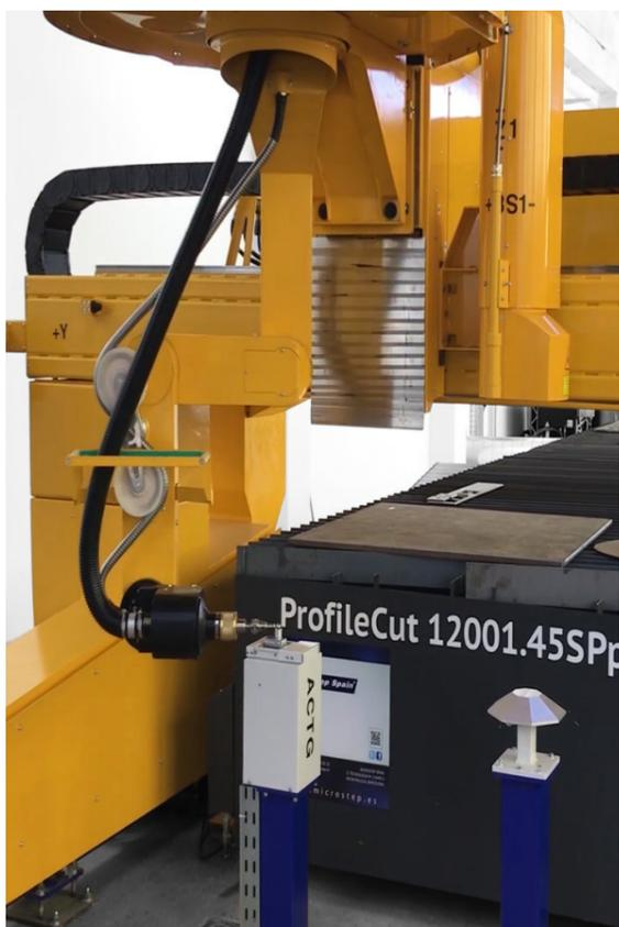
El sistema de calibrado ACTG® permite obtener resultados duraderos de alta precisión. Este cabezal de corte 3D especializado con capacidad de inclinación de 120° se mueve alrededor del perfil en sentido longitudinal y transversal.
