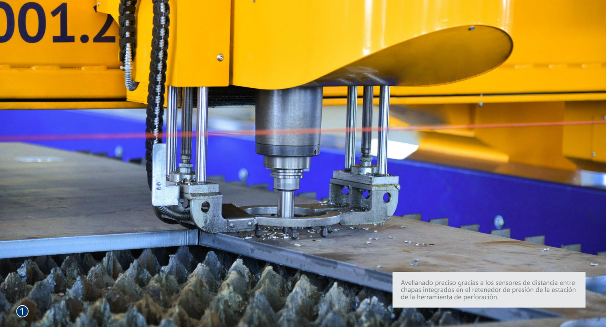
Avellanado preciso gracias a los sensores de distancia entre chapas integrados en el retenedor de presión de la estación de la herramienta de perforación.
