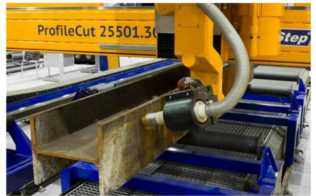
MicroStep ha desarrollado una gran variedad de soluciones para el procesamiento 3D de alta precisión de tubos, perfiles y vigas, incluida la manipulación de materiales totalmente automatizada..
