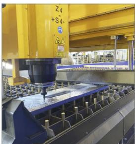
Produzca sus piezas con orificios ya taladrados, avellanados, roscas o aberturas fresadas y preparaciones de soldadura: ¡las tecnologías de mecanizado complementarias convierten las máquinas de corte MicroStep en centros de producción multifuncionales!
