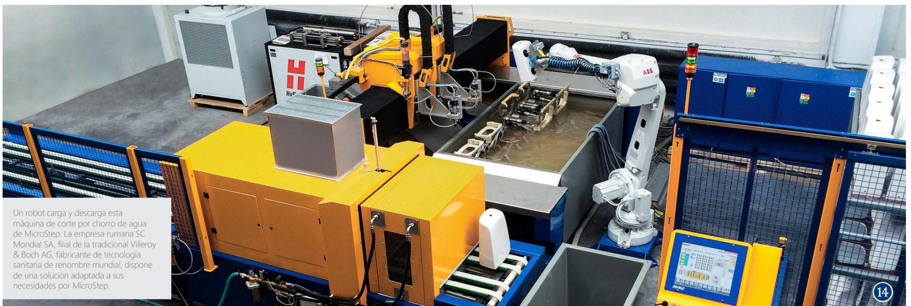
Un robot carga y descarga esta máquina de corte por chorro de agua de MicroStep. La empresa rumana SC Mondial SA, filial de la tradicional Villeroy & Boch AG, fabricante de tecnología sanitaria de renombre mundial, dispone de una solución adaptada a sus necesidades por MicroStep.
