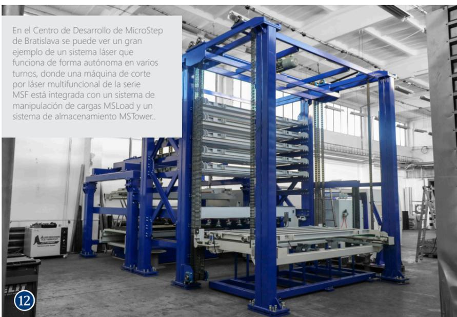
En el Centro de Desarrollo de MicroStep de Bratislava se puede ver un gran ejemplo de un sistema láser que funciona de forma autónoma en varios turnos, donde una máquina de corte por láser multifuncional de la serie MSF está integrada con un sistema de manipulación de cargas MSLoad y un sistema de almacenamiento MSTower.
