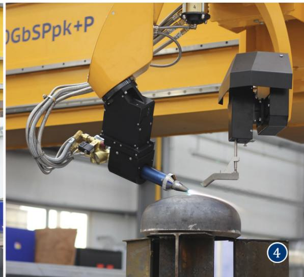
Corte en bisel de una cúpula más pequeña con plasma (izquierda) y oxicorte (derecha). La máquina puede cortar cúpulas de hasta Ø 2.000 mm y 600 mm de altura.
