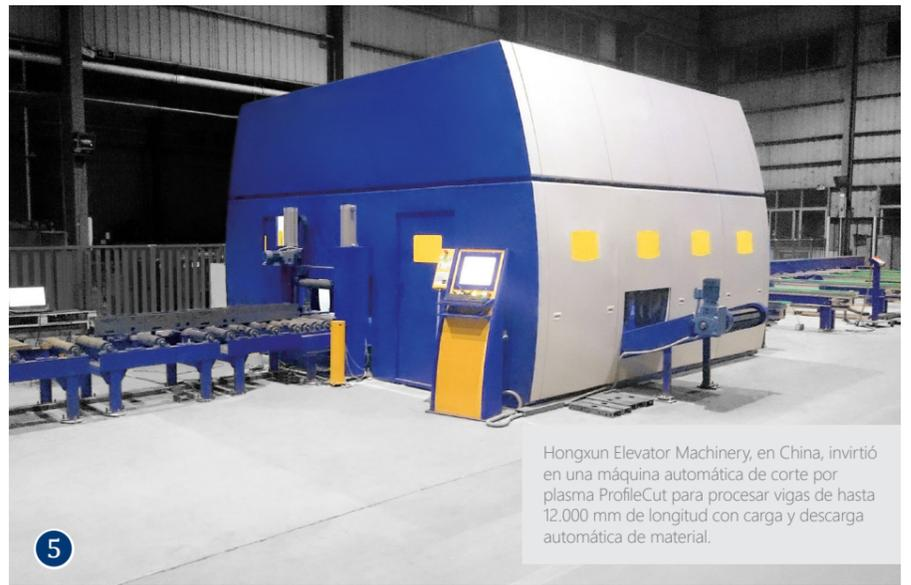
Hongxun Elevator Machinery, en China, invirtió en una máquina automática de corte por plasma ProfileCut para procesar vigas de hasta 12.000 mm de longitud con carga y descarga automática de material.
