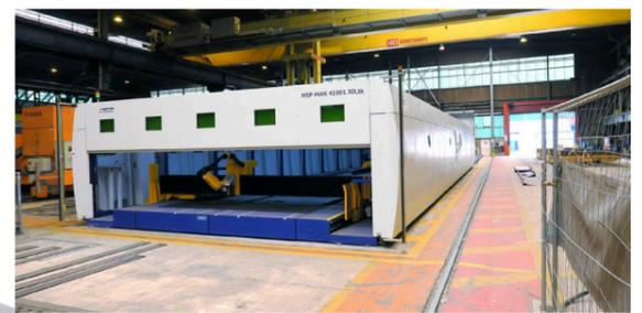
La máquina está equipada con un cabezal de corte en bisel con fuente láser de 8 kW que permite realizar la preparación de bordes de soldadura en piezas de hasta 20 m de longitud con espesores de hasta 16 mm y ángulos de bisel de hasta 45°.
