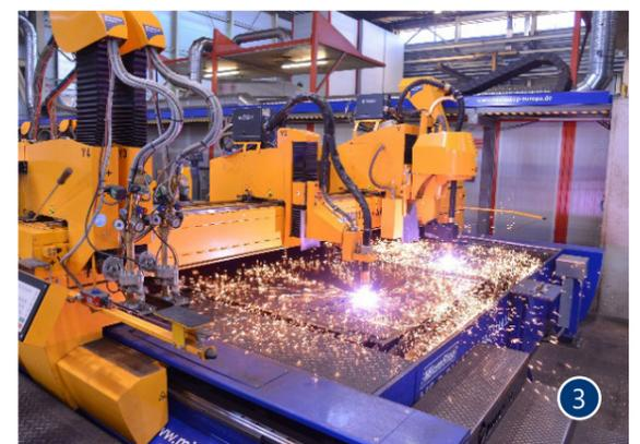
Para la empresa Doppelmayr MicroStep instaló una potente taladradora de la serie DRM 1 y dos máquinas de corte por plasma y oxígeno de la serie MG con dos pórticos 2 + 3. Las dos máquinas MG están equipadas cada una con una cámara CCD 4 para una máxima precisión al cortar piezas pretaladradas.
