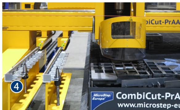
Cabezal de taladrado con refrigeración interna y cambio automático de herramientas, con almacenes automáticos para 16 herramientas.
