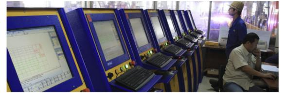
Funcionamiento 24/7: La línea de corte automatizada (izquierda) de ZMJ se controla desde una sala de control central (arriba). Un total de ocho máquinas de corte por plasma CNC de MicroStep se cargan y descargan automáticamente mediante una grúa de proceso Demag.
