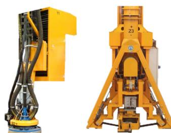
Soluciones para la eliminación de una fina capa de superficie (por ejemplo, color de imprimación) de la chapa mediante tecnologías de granallado o esmerilado.
