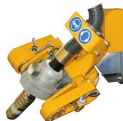
El cabezal de corte biselado de plasma con una capacidad de inclinación de hasta  $50^\circ$  permite realizar una gran parte de los trabajos de corte de bisel comunes.
