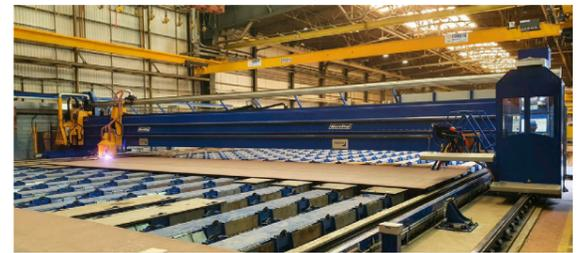
En 2020, el astillero invirtió en dos líneas de procesamiento de paneles que incluyen dos pódicos MicroStep de 20,5 m de ancho para corte en bisel, eliminación de imprimación y el marcado de paneles a gran escala.
