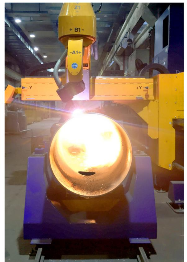
Arriba izquierda + derecha: Las tres máquinas combinadas de corte de tubos y cúpulas de la serie PipeCut de Gree permiten cortar tubos de hasta Ø 610 mm y una longitud de 12 m, así como cúpulas de hasta Ø 1.200 mm. Abajo a la izquierda: Gree Electric Appliances Inc. participó en proyectos como el Estadio Nacional (Soccer City) de Johannesburgo, en Sudáfrica.
