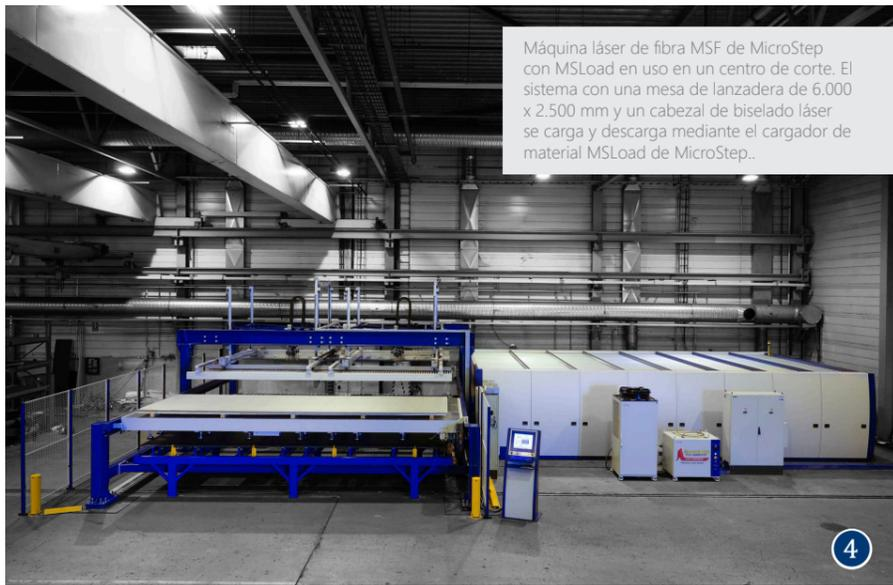
Máquina láser de fibra MSF de MicroStep con MSLoad en uso en un centro de corte. El sistema con una mesa de lanzadera de 6.000 x 2.500 mm y un cabezal de biselado láser se carga y descarga mediante el cargador de material MSLoad de MicroStep..
