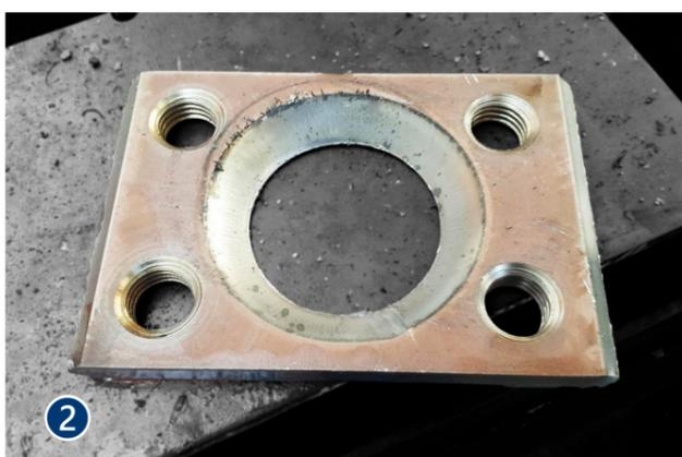
**2** Pieza Hardox taladrada, roscada y cortada en bisel con plasma en una máquina MicroStep DRM.
