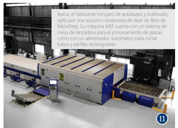
Ikarus, el fabricante húngaro de autobuses y trolebuses, optó por una solución combinada de láser de fibra de MicroStep. Su máquina MSF cuenta con un sistema de mesa de lanzadera para el procesamiento de placas como con un alimentador automático para cortar tubos y perfiles rectangulares.
