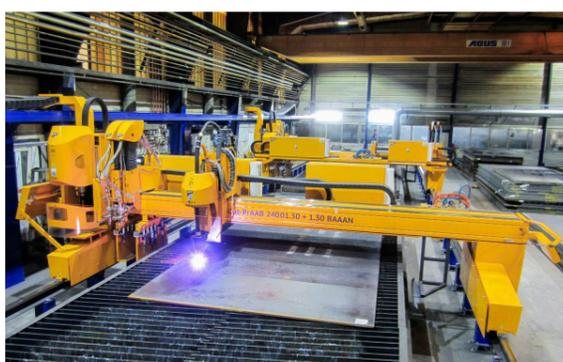
La solución combinada de corte por plasma y oxicrote de MAP Prinzing Brennschneidtechnik GmbH permite el corte en bisel con plasma, oxicrote 2D, taladrado, roscado y marcado en dos pórticos. A petición de la empresa, se añadió un almacén de 16 herramientas.
