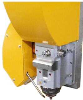
Cabezal láser para corte con gran precisión con tecnología de láser de fibra 2D.
