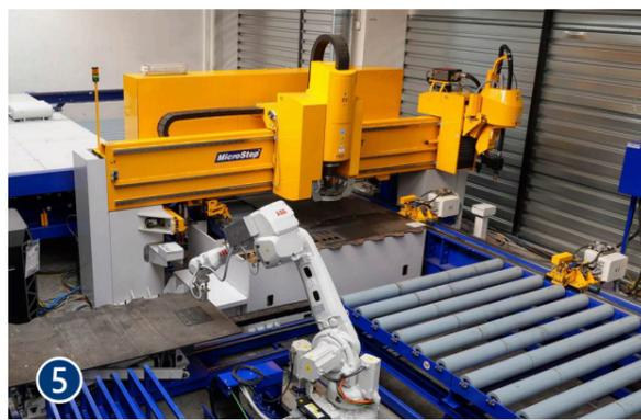
Línea de procesamiento de chapas MicroStep DS con una perforadora de 55 kW dedicada a la producción automatizada de bridas.
