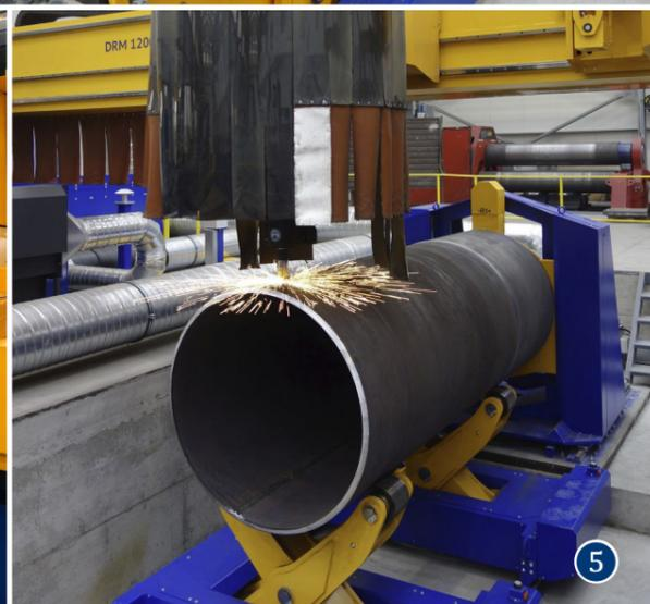
Corte de tubos por plasma. El gran posicionador permite cortar tubos de hasta Ø 2.000 mm, 6 m de longitud y 7 toneladas de peso.
