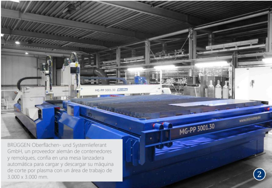
BRÜGGEN Oberflächen- und Systemlieferant GmbH, un proveedor alemán de contenedores y remolques, confía en una mesa lanzadera automática para cargar y descargar su máquina de corte por plasma con un área de trabajo de 3.000 x 3.000 mm.
