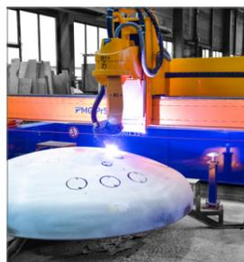
El paso básico en la producción de recipientes a presión es el corte preciso de los extremos abombados. La automatización de este proceso y la obtención de contornos de alta precisión sin necesidad de un acabado de la superficie, proporciona a los fabricantes una clara ventaja y les ahorra tiempo.
