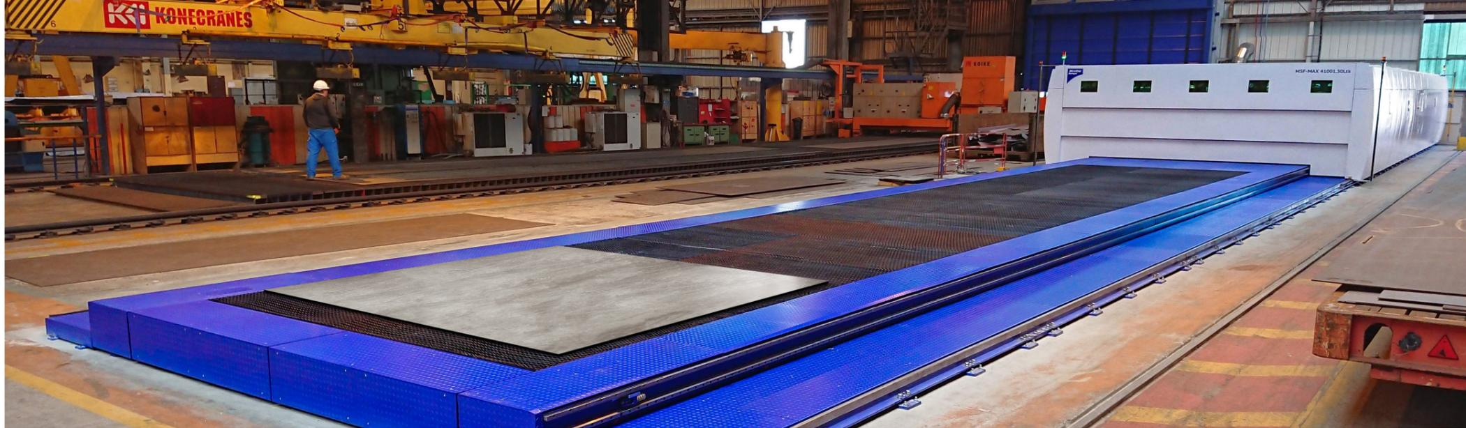
**Arriba:** Chantiers de l'Atlantique optó por invertir en una gran cortadora láser de fibra MSF Max. Se trata de una máquina de 50 m de longitud con dos zonas de corte de 21.000 x 3.500 mm.
