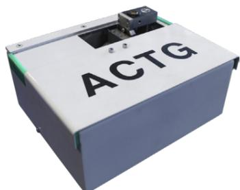
La estación ACTG proporciona la calibración automática de cabezales de biselado para la compensación automática de la imprecisión mecánica del cabezal de corte, así como la calibración del escáner ABP y la medición automática de las herramientas de perforación.
