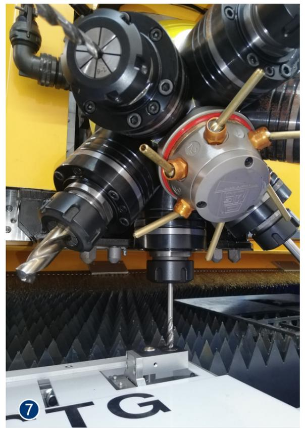
Calibración de un cabezal de taladro de torreta en una máquina láser de fibra con opción de taladrado/tapado/contraentrelazado.
