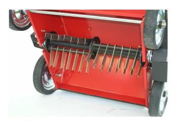
Autolimpiante. El motor lleva montadas cuchillas de corte flotantes ( por impacto ) que no proyectan cuerpos extraños al exterior
