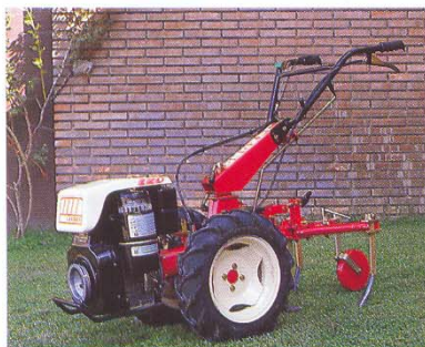
Foto superior izquierda: LANDER 120 con ruedas 6-12 y fresa rotativa.
