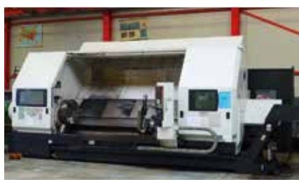
CNC MAZAK SLANTTURN N60 Ø 915 X 3200
