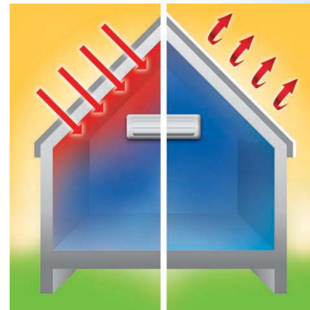
Penetración y reflexión de ondas de calor sin recubrimiento y con recubrimiento termorreflectante KOFATERM ROOF
