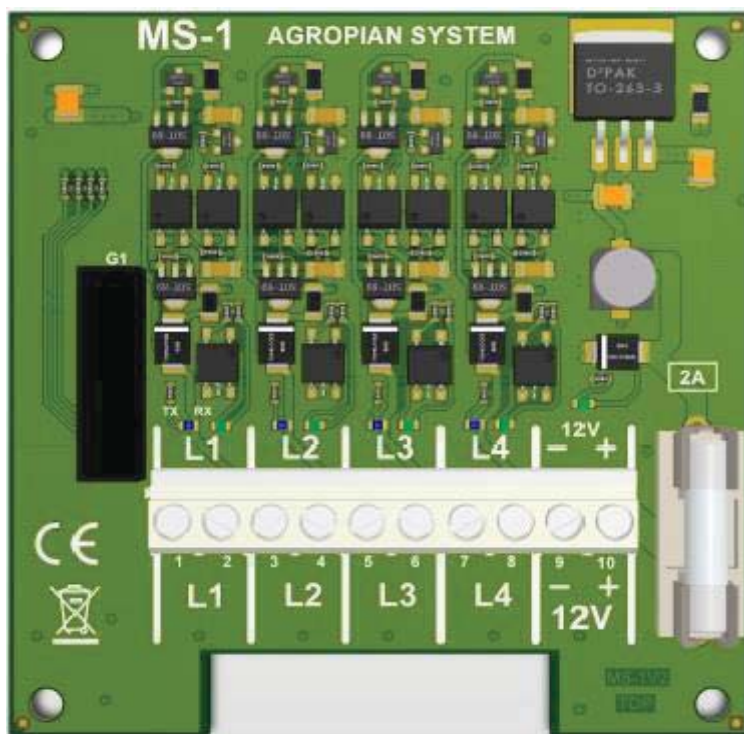
Fig. 1: Esquema de colocación de los terminales de la tarjeta del controlador MS-1.
