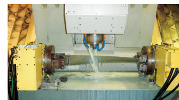
Dos unidades CNC401 en rotación sincronizada
