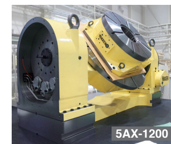
Un divisor CNC802 (1100 Kg.) siendo usado como carga en un divisor 5AX-1200
