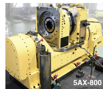
Dos unidades de CNC501 (940 Kg.) siendo empleadas como carga en un divisor 5AX-800
