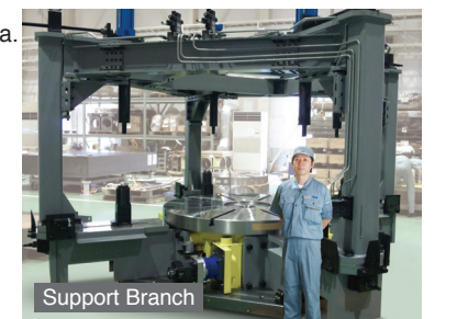
CNC1800 y estructura de apoyo Indexación / sujeción del anillo de la turbina
