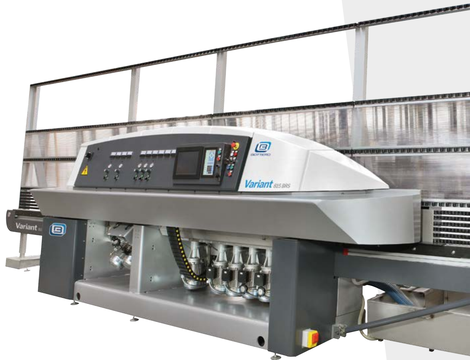
Canto plano con biselado sobredimensionado hasta 45°
