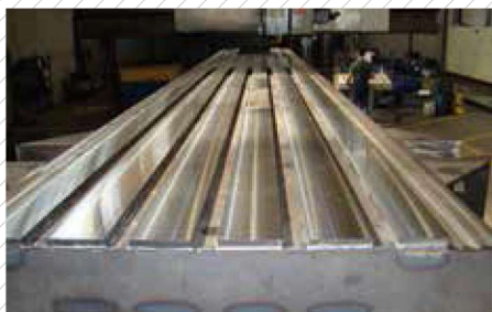
Fresatura del basamento Milling of the base frame Fresado de la base
