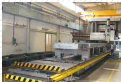
Fresatura interna della struttura Internal milling of the structure Fresado interno de la estructura
