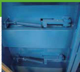
Trattenitori superiori e laterali del materiale compattato
