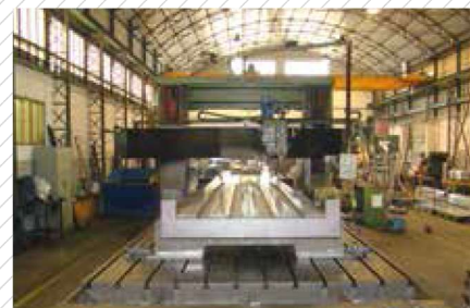
Foratura interna della struttura Internal drilling of the structure Perforación de la carretilla de compactación
