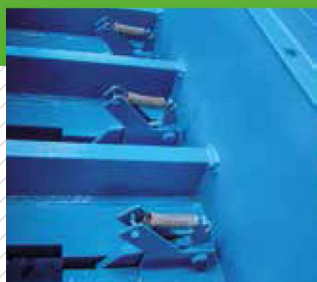
Trattenitori superiori e laterali del materiale compattato
