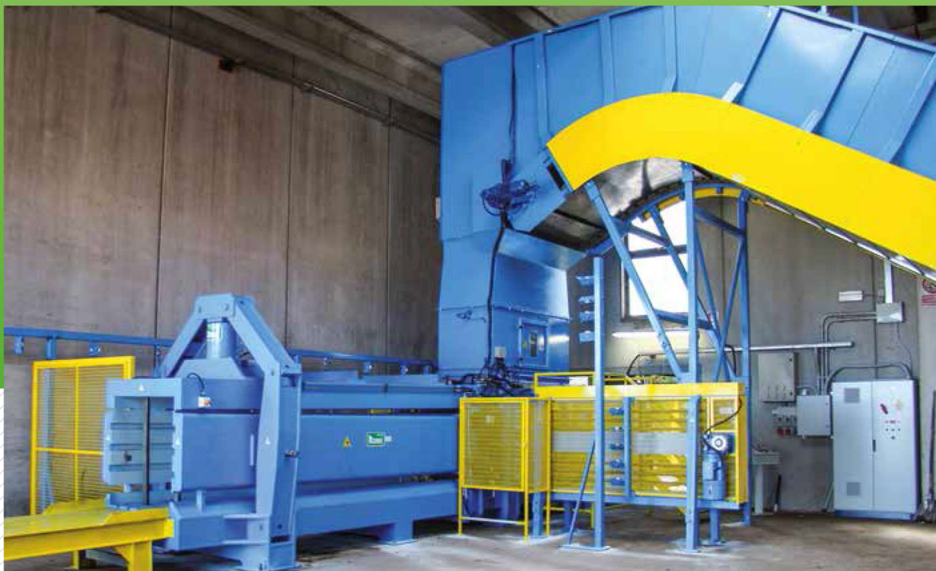
Pressa PMC-WA-150 con sistema di legatura orizzontale PMC-WA-150 press with horizontal tying system Prensa PMC-WA-150 con sistema horizontal de atadura
