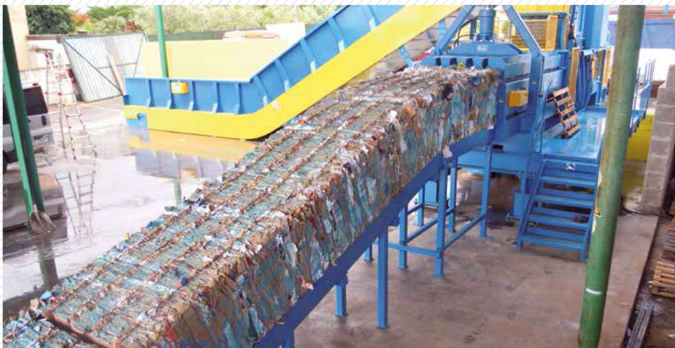
Pressa PMC-WA-150 con sistema di legatura orizzontale PMC-WA-150 press with horizontal tying system Prensa PMC-WA-150 con sistema horizontal de atadura
