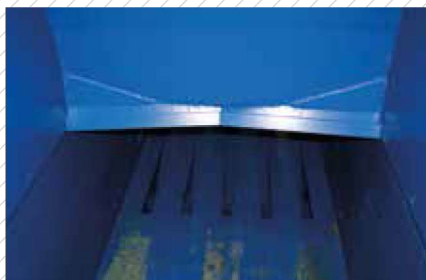
Coltello intercambiabile in Hardox®
