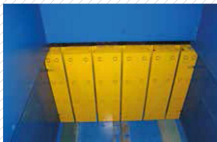
Testata carrello spintore e pareti camera di compattazione con rivestimento Hardox® intercambiabile
