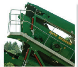
Pasarelas Fijas de acero galvanizado.
