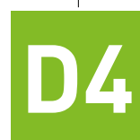
Uso exterior expuesto a la intemperie
