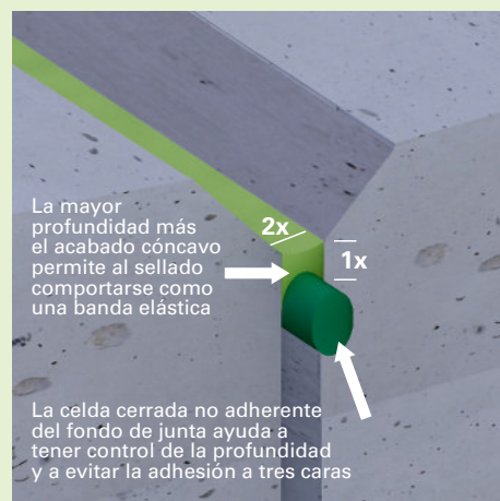
Junta entre paneles prefabricados de hormigón
