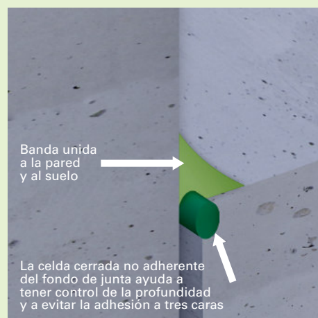
Junta entre el suelo y la pared
