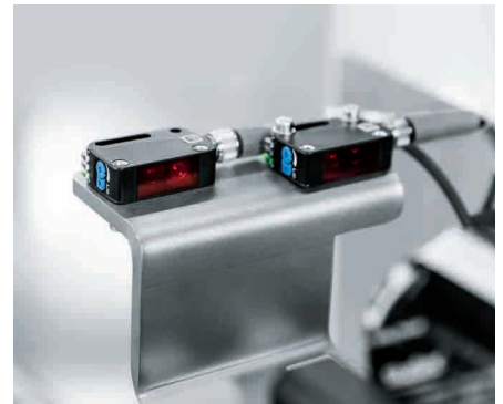
El sensor optoelectrónico más pequeño de su clase: SOOE.
