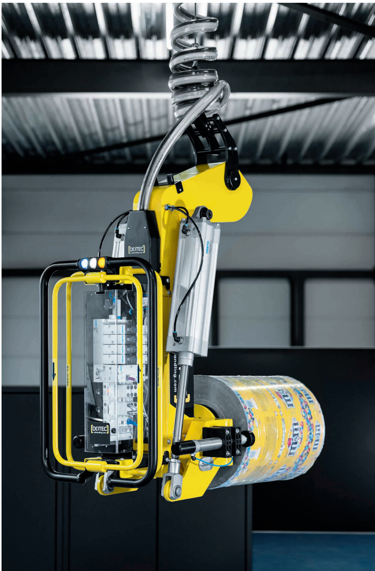
Sujeción, inclinación, movimiento vertical: el Motion Terminal controlado por aplicaciones garantiza la máxima flexibilidad en todos los movimientos. Estos son, al igual que la colocación de la carga, suaves y rápidos.
