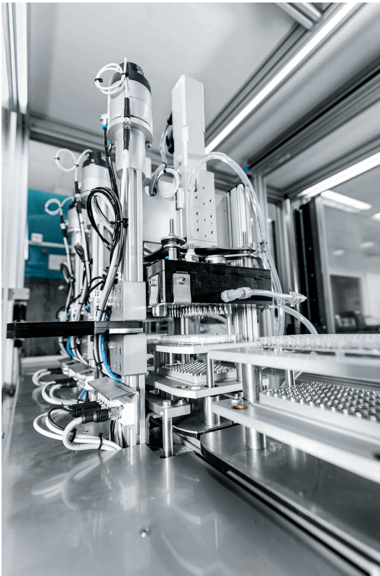
Un carro eléctrico de tipo EGSC mueve hacia abajo la cabeza de succión que suministra líquido a las placas microtituladoras en varias estaciones de lavado.
