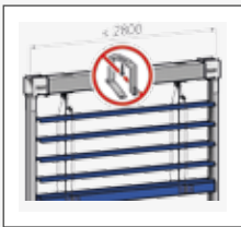
El sistema de persianas autoportante
