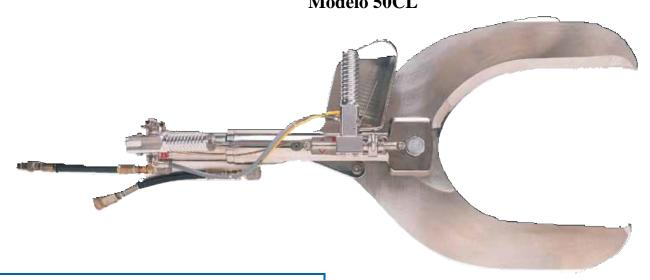
El Modelo 50CL de Jarvis: gotero hidráulico de cuartos delanteros y lomo.
