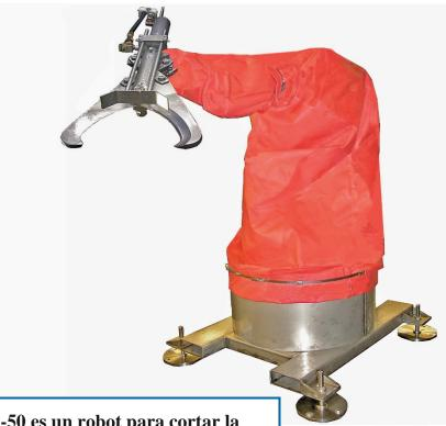
El Modelo JR-50 es un robot para cortar la cabeza de porcino con operaciones de corte continuo en el matadero.
