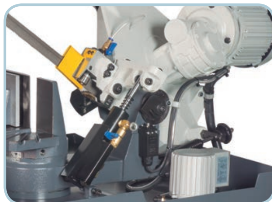
Bajada hidráulica (CY-270-N-BH) Hydraulic descent (CY-270-N-BH)
