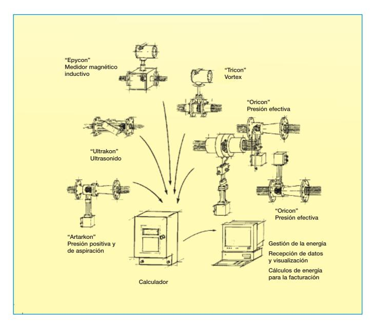
Equipos elegidos según requerimientos del tipo de producto a medir, viscosidad, conductividad, zona clasificada o no, temperatura y presión de servicio. Existen modelos para temperaturas hasta 500°C y presión hasta 63 bares. En combinación con convertidores propios y la electrónica correspondiente, se pueden medir caudales, gases y vapores en m3, Nm3, kilos, etc., así como, directamente energía, con una gran presión y un amplio rango de medición.
