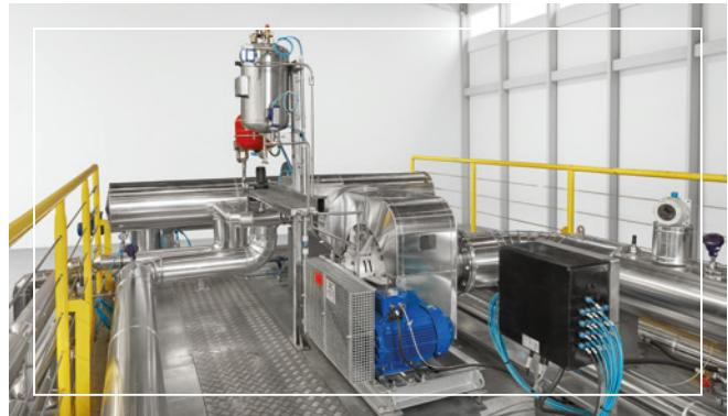
**Sala de gases:** Clasificada como ATEX zona 1, la sala de gases debe estar separada de la cámara. Tenemos un diseño especial para permitir el cambio automático de los contenedores ETO, colocados en básculas de peso.
