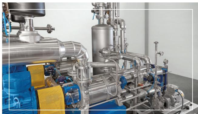
**Generador de vapor:** Para humidificar la carga dentro de la cámara o de la sala de pre-condicionamiento, se requiere un generador de vapor puro. Se pueden elegir dos diseños: eléctrico o de tipo intercambiador de calor. Nuestros equipos siguen las recomendaciones GMP y proporcionan vapor saturado de alta calidad.
