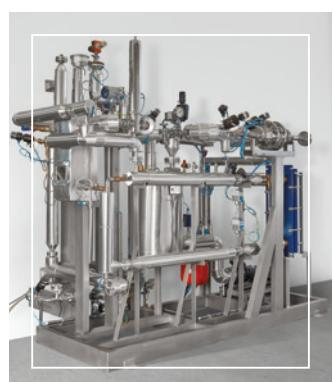
**Salas de Pre-condicionamiento y de desgasificación:** Para reducir el tiempo del ciclo, se puede instalar salas de pre-condicionamiento y de desgasificación, generalmente en línea con la cámara. Para las salas de desgasificación, los residuos de ETO son eliminados y se inyecta aire nuevo. Nuestro diseño proporciona una excelente uniformidad de temperatura.
