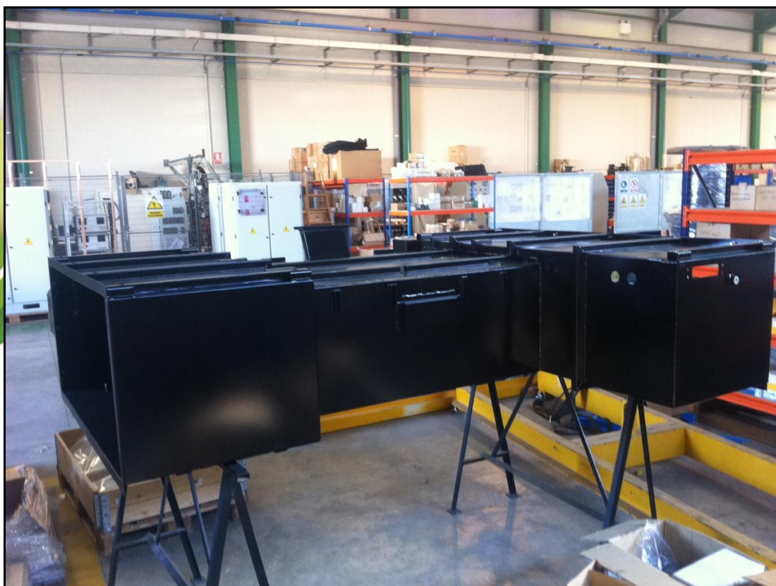
Fabricación caja de baterías
