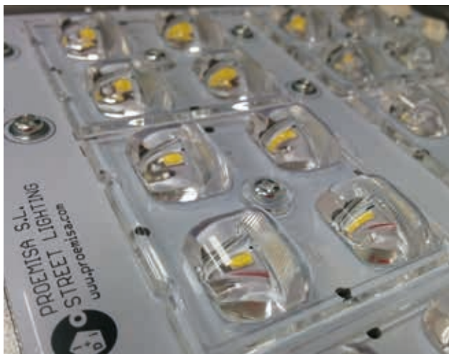
mcPCB diseñado y ensamblado en la línea SMD de PROEMISA
