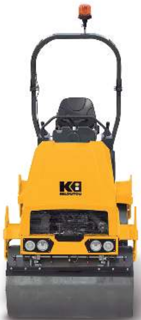
Rodillo vibrante tándem diésel 2,7 t > Anchura de trabajo de 1,2 m
