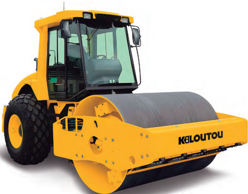
Rodillo monocilíndrico 13 t > Anchura de trabajo de 2,13 m
