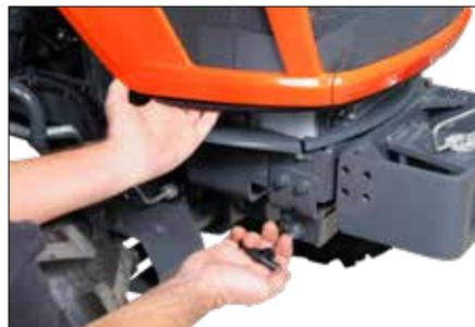
Acceso al capó sin herramienta para el EK1-261 o con la herramienta dentro de la caja de herramientas para los demás.
