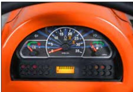
Un sensor en el salpicadero indica cuando el filtro de aire necesita limpieza, simplificando el mantenimiento.
