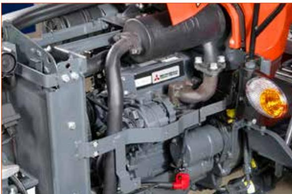
Los robustos motores diésel Stage V de 3 cilindros de 22 CV y 25 CV de Mitsubishi están refrigerados por agua. El motor de 4 tiempos cuenta con inyección de cámara de turbulencia que aspira aire a través del filtro de aire.
