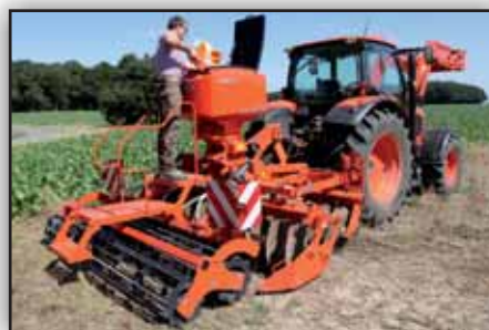
El Robusto chasis permite la incorporación de la SH de 200 e incluso de 500 litros.
