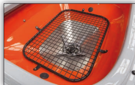
Agitador y criba de tolva
