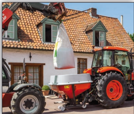
Baja altura de carga.
