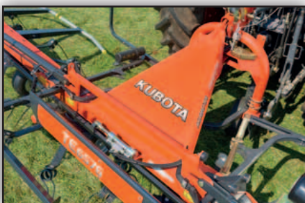
Robusto bastidor con el cabezal principal del mismo en forma de "V".
