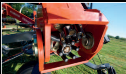
Accionamientos HexaLink que permiten plegar a 180° en transporte.
