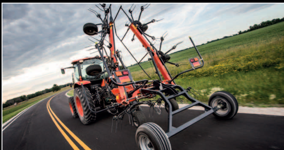
En estos modelos el paso de posición e trabajo a transporte se realiza hidráulicamente desde la cabina del tractor.
