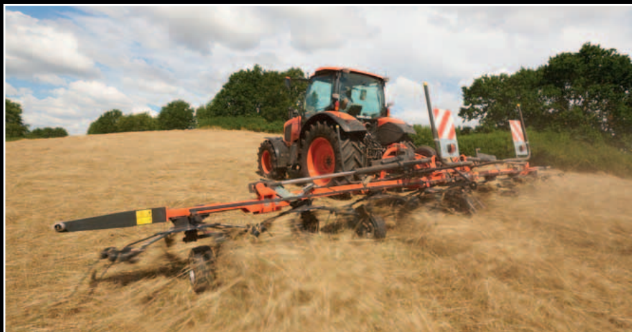
Con un ancho de trabajo de 9,00 metros, el henificador Kubota TE8590 cuenta con 8 rotores, un total de 48 púas dobles y un ancho de trabajo que sienta un nuevo estándar en cuanto a eficiencia en el henificado.
