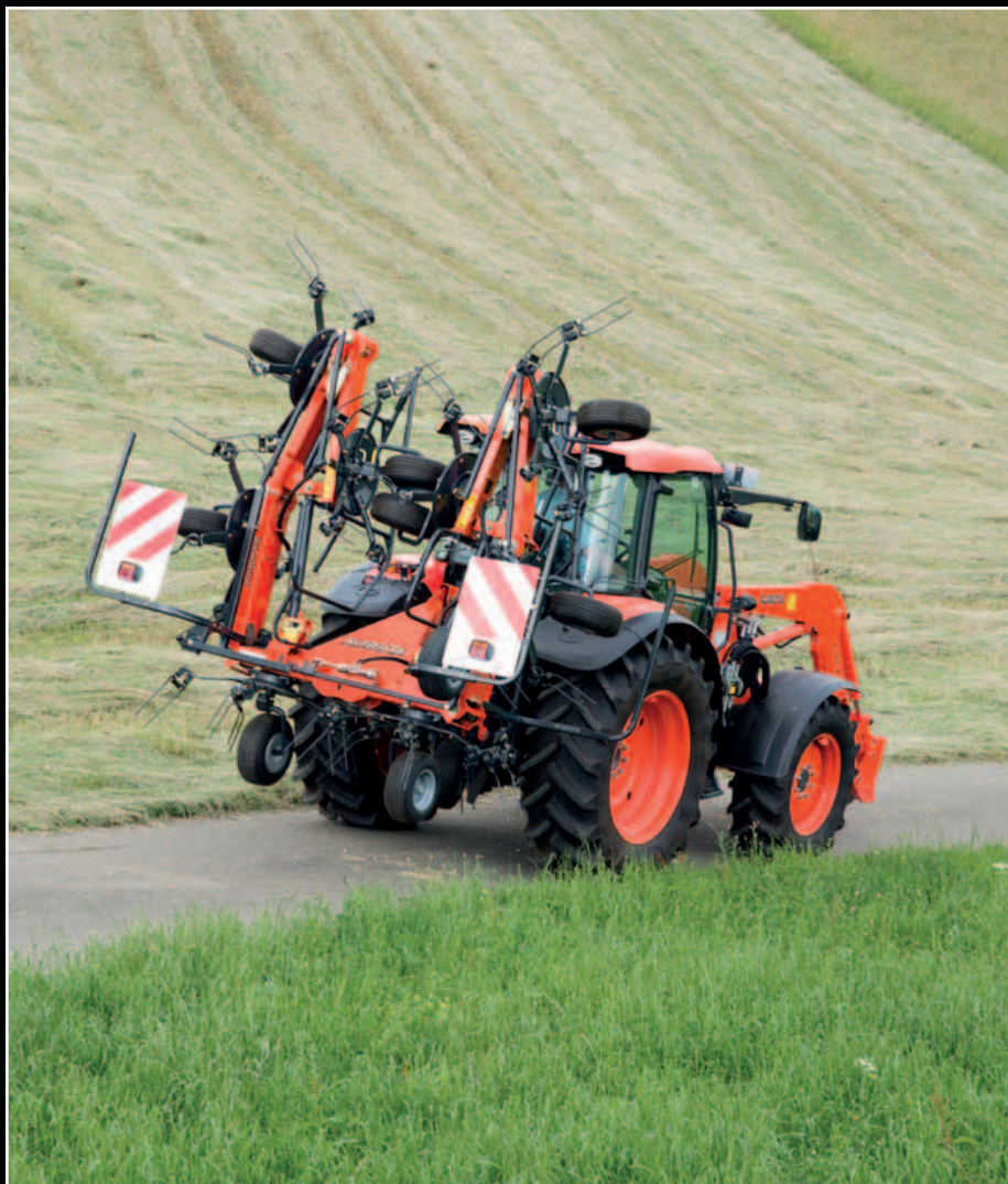
TE8080 se pliega en una posición muy compacto para el transporte.
