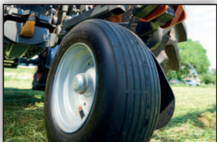
El henificador Kubota TE6576 puede equipar una rueda en el cabezal para facilitar el ajuste correcto de la máquina.
