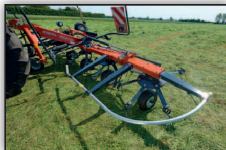
Protecciones de aluminio: Ligeras y resistentes.
