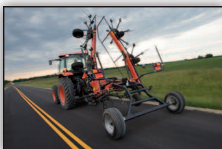
En trabajo el peso del bastidor portante queda centrado.
