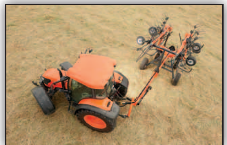
El cabezal permite giros de hasta 80°.
