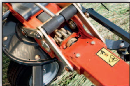
La transmisión HexaLink, permite que pivoten 180° sobre si mismos.
