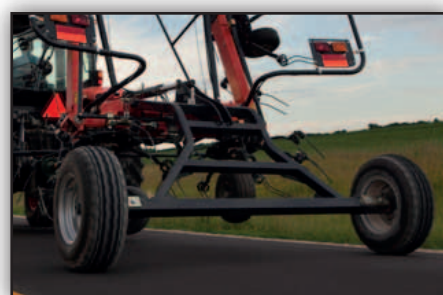
El amplio ancho de vía permite circular a elevadas velocidades.
