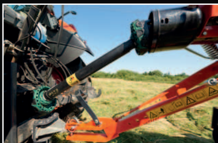
Tomas de fuerza con doble nudo homocinético para mayor maniobrabilidad.
