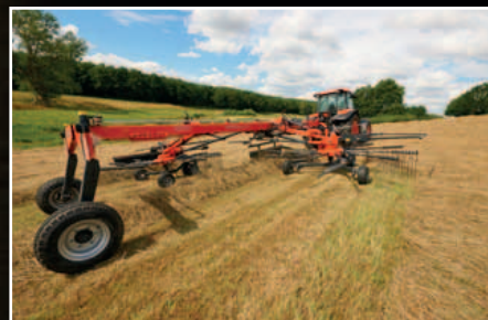
El modelo RA2069 VARIO puede trabajar formando dos hileras simultáneamente.
