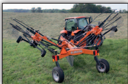
El cabezal giratorio y los ejes direccionales son claves para la maniobra en cabeceras.
