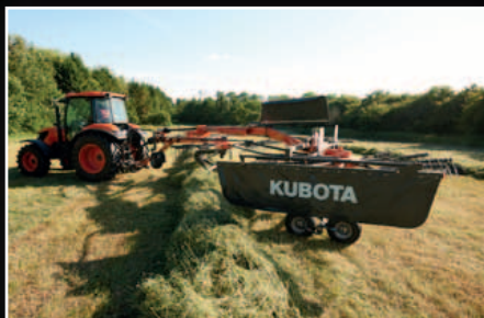
El amplio despeje de 50 cm permite sobrepasar las hileras sin problemas.
