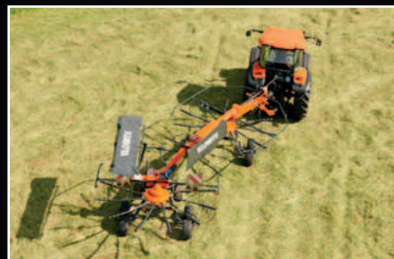
SideShift a izquierda: Rastrillado sin pasar por encima del forraje segado.
