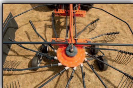
Los grupos ProLine, libres de mantenimiento, aseguran la fiabilidad de los rastrillos. Tanto brazos como soportes pueden desmontarse fácilmente.
