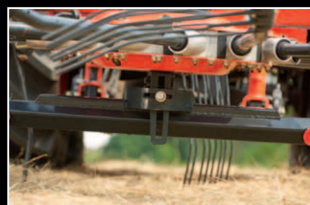
Regulación exterior de la leva del rotor para optimizar el rastrillado y adaptarlo al cultivo.
