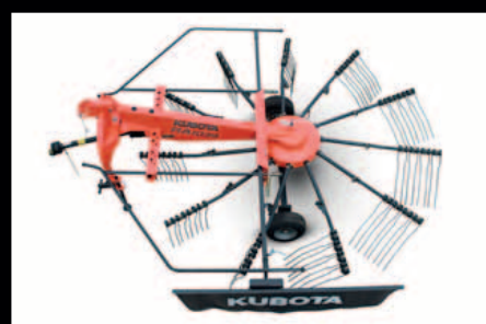
RA1039: Con un peso de 460 kg, este modelo tiene 3,90 m de ancho de trabajo.
