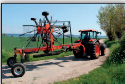
Para limitar la altura de transporte, los brazos del RA2076 pueden desmontarse. La lona hileradora se pliega hacia arriba automáticamente.
