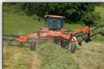
El control independiente de los rotores en el modelo RA2072 facilita el trabajo en las cabeceras del campo o en presencia de obstáculos.
