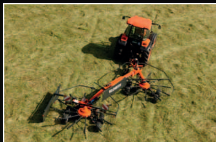
SideShift a derecha: Rastrillado cerca de obstáculos sin variar la dirección de marcha.
