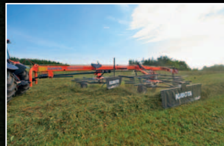
La posición baja de la parte posterior del bastidor hace descender el centro de gravedad.
