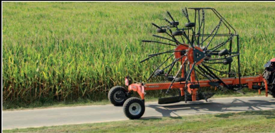
Ancho de trabajo de 9,0 metros y por debajo de 4,0 m en transporte, sin desmontar púas...
