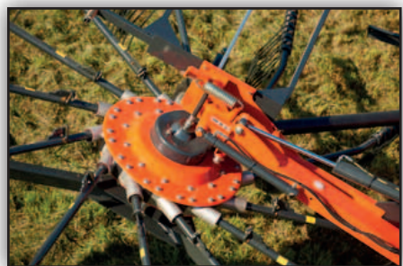
Ajuste hidráulico del ancho entre 7,60 y 8,40 metros en el RA2584 y 8,0 y 9,0 metros en el RA2590 Hydro.
