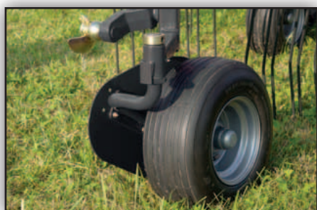
La rueda de soporte del cabezal (opcional) mejora el seguimiento del terreno en parcelas muy irregulares.
