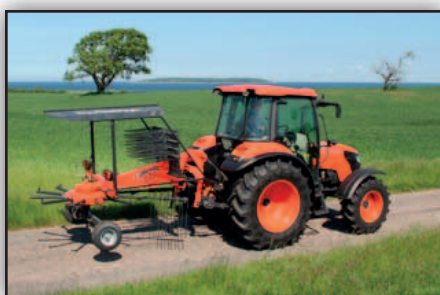
Puede reducirse el ancho de transporte, desmontando los brazos y situándolos en los alojamientos del cabezal.
