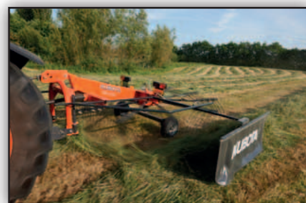
El cabezal pivotante asegura un perfecto seguimiento del terreno, incluso en curvas. Sistemas de amortiguación de oscilaciones están disponibles como opcional.
