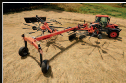
El cabezal permite giros de hasta 80°. Soberbia maniobrabilidad.
