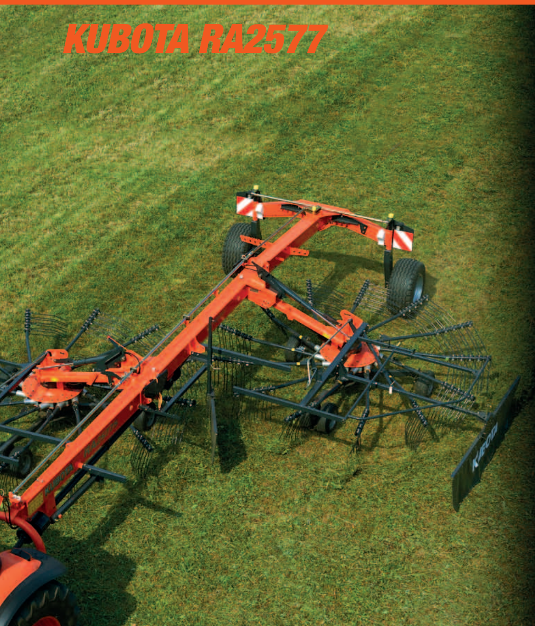
La posición baja de la parte posterior del bastidor hace descender el centro de gravedad.
