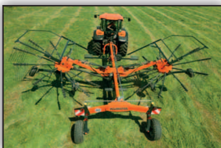
RA2076 - Ajuste hidráulico de los rotores entre 7,0...
