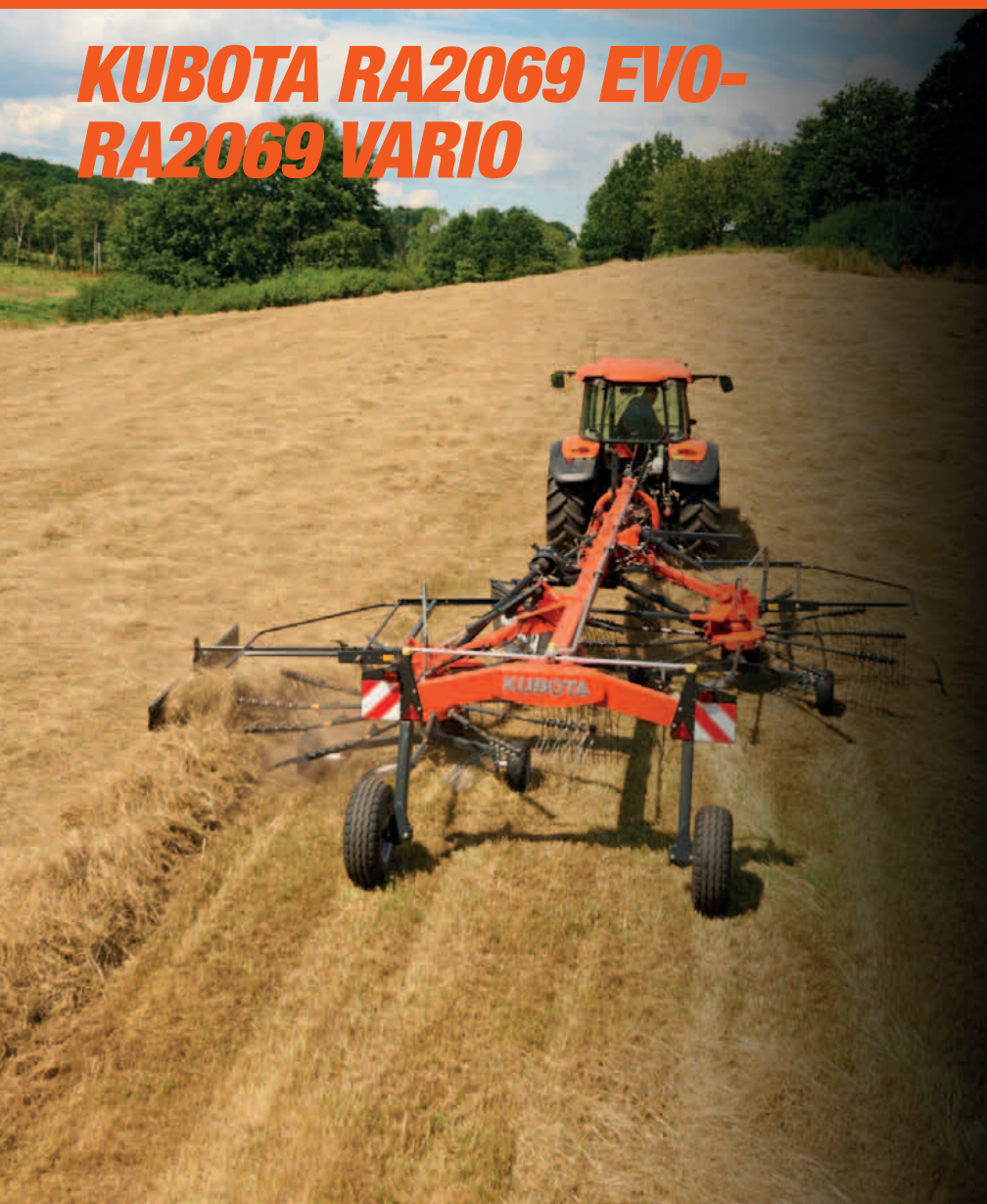
Generoso solape entre rotores para un rastrillado limpio.
