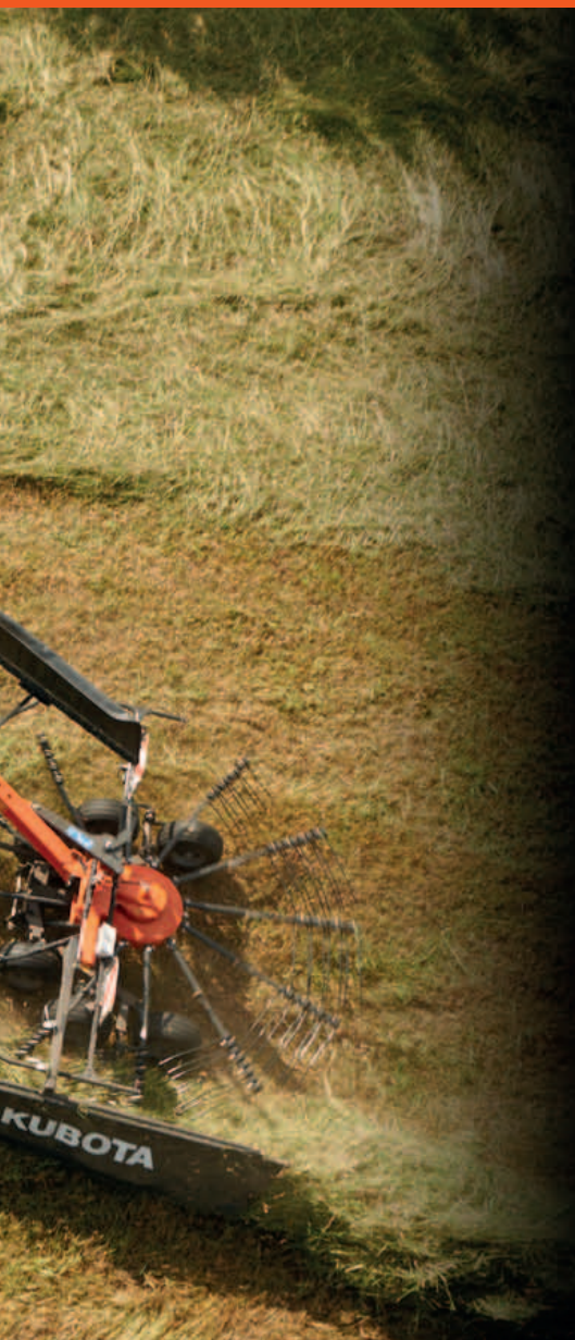
El amplio despeje de 50 cm permite sobrepasar las hileras sin problemas.
