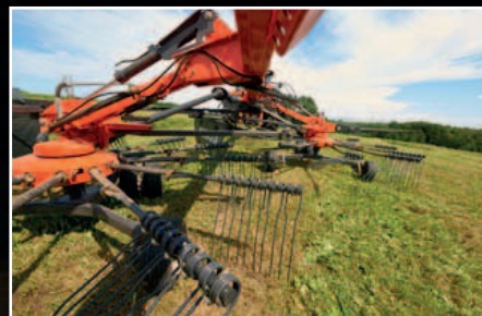
Generoso solape entre rotores para un rastrillado limpio.
