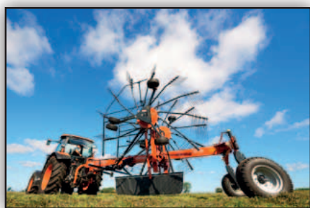
El paso a posición de transporte se realiza desde la cabina del tractor.
