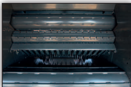
El concepto de la BF 2255: 6 rodillos en la parte frontal...
