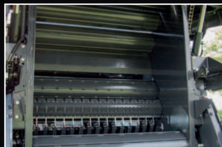
Cámara PowerMax: 17 rodillos reforzados para máxima productividad.
