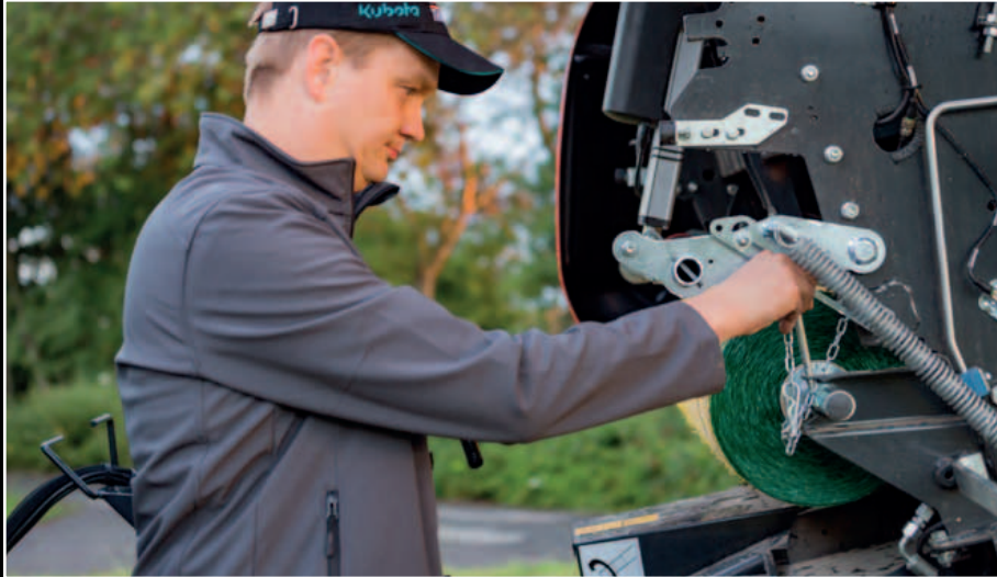
La baja altura de carga facilita el reemplazo de las bobinas de malla.
