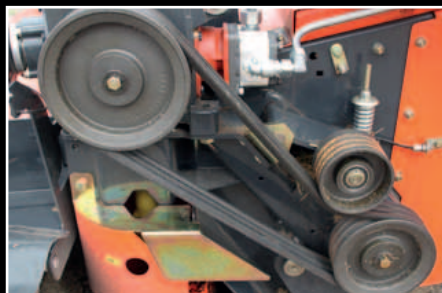
Ajuste de la velocidad del rotor acondicionador.
