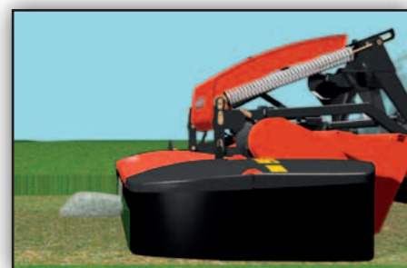
El sistema de suspensión protege la máquina frente obstáculos.
