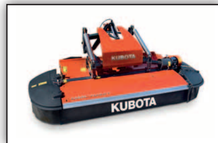
DMC7000T/R: Segadoras acondicionadoras frontales con acondicionadores de mayales SemiSwing o rodillos. Anchos de trabajo de 2,80 y 3,20 m.
