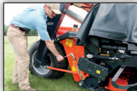
Fácil ajuste de la altura de corte.
