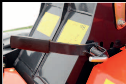
Ajuste del paladar acondicionador en tres posiciones.
