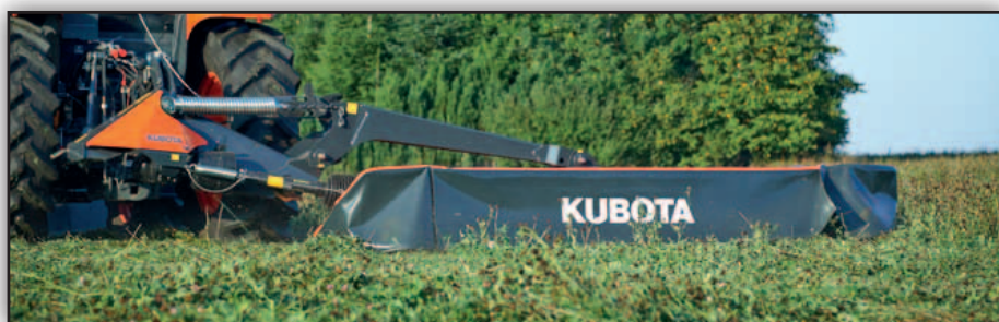
El sistema pendular se adapta de un modo rápido y preciso al perfil del terreno.
