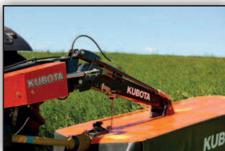
Suspensión central con óptimo reparto de pesos y perfecta adaptación.
