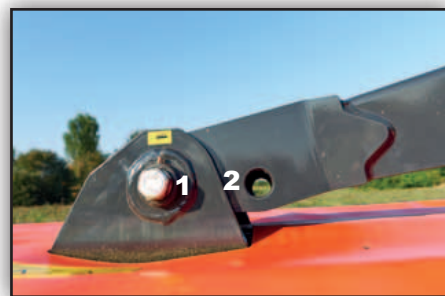
Dos posiciones de montaje para optimizar el solape con segadoras frontales.
