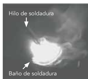
Soldadura Super Zi-Active con excelente resultado
