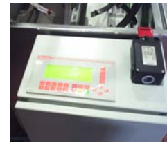
Programador electrónico de tiempo de limpieza y de parada del avance en zonas donde concentra mayor suciedad.
