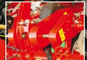
Carter di protezione per catene di trasmissione Protective casing for the transmission chains Carter de protection pour chaînes de transmission Защитный кожух трансмиссионных цепей
