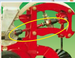
Cardano di trasmissione al distributore Distributor driveline Cardan de transmission au distributeur Трансмиссионный кардан распределителя
