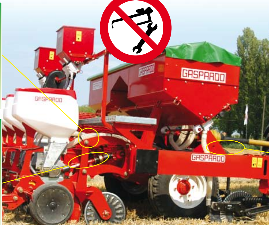
Cardano di trasmissione al distributore Distributor driveline Cardan de transmission au distributeur Трансмиссионный кардан распределителя
