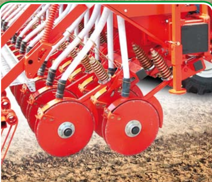
Doppelscheibenschar mit einstellbarer Druckfeder Subsolador de doble disco con resorte de compresión regulable Assulador de duplo disco com mola de compressão regulável
