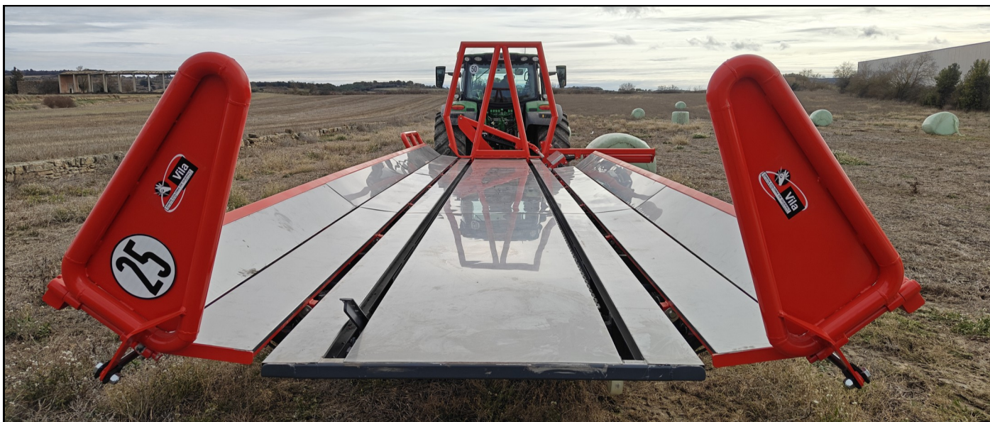
Base y laterales con su forrado INOX para una mejor descarga de los bolos plastificados. Laterales abiertos a su máximo
