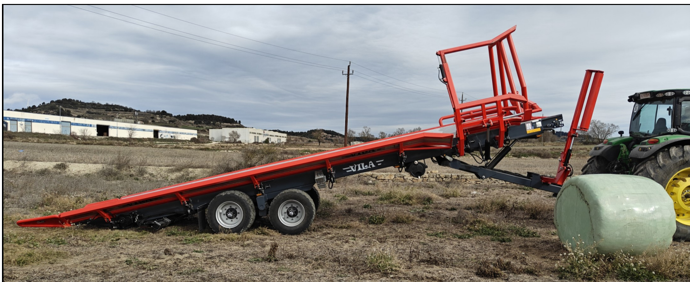
Vista lateral, remolque basculando para descarga
