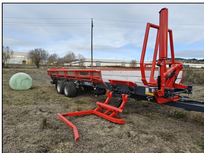
Posición de carga con la apertura hidráulica de la pinza abierta
