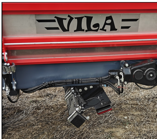
Parachoques plegable hidráulico
