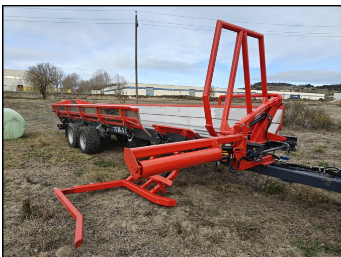
Posición de carga con la apertura hidráulica de la pinza abierta y brazo gira-bolos en posición de trabajo
