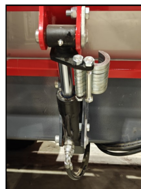
Laterales abatibles con tope de posicionamiento
