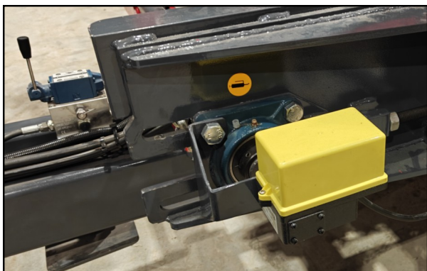
Final de carrera electrónico para el desplazador de pacas
