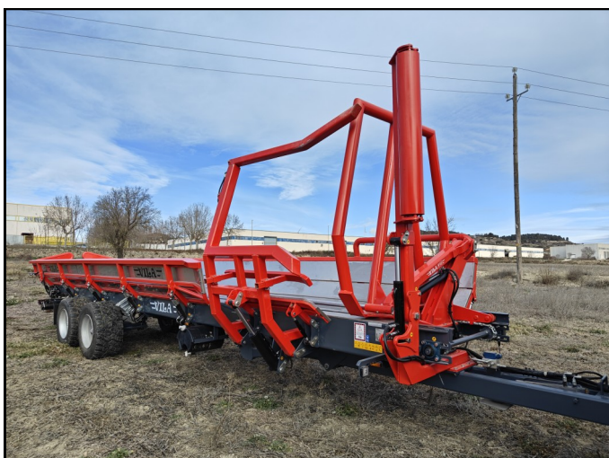
Laterales, pinza y brazo gira-bolos en posición de transporte en vacío
