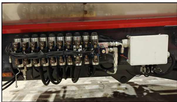
Conjunto placa de electroválvulas + cuadro eléctrico
