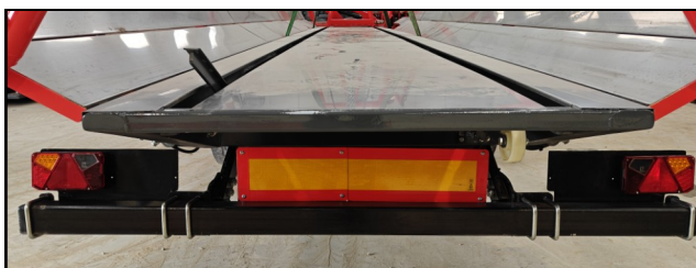
Parachoques plegable hidráulico
