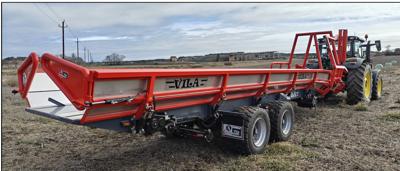
Vista lateral trasera, parachoques recogido hidráulicamente para mayor seguridad durante movimientos en el campo
