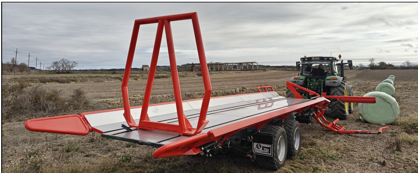
Puerta trasera abierta para descarga y desplazador de bolos en final de recorrido
