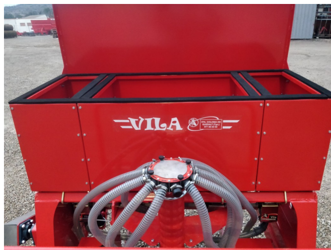
3 tolvas para la siembra de 3 o 4 semillas distintas con dosificadores independientes.
