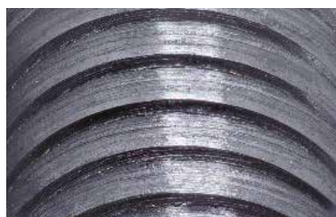
Después de roscar 184 agujeros con el VUSP CH, el acabado de la superficie sigue siendo excelente.
