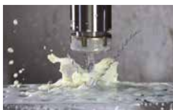
Expulsión con presión a 1,5 MPa (15 Bar)
