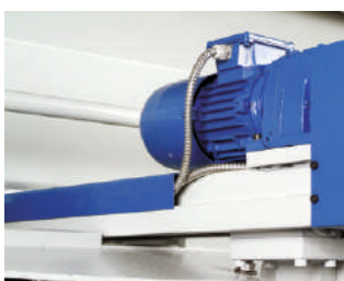
▶ Automático basculado del tope al final de la carrera 1000mm, facilita el corte de chapas largas
