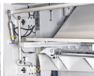
▶ Automático ajuste de la separación de las cuchillas
