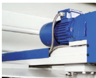
▶ Automático basculado del tope trasero al final de la carrera (1000mm)
