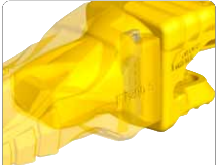
Sistema compuesto de diente, portadiente y pasador. Variedad de diseños. Gama completa de tamaños: tallas de la 130 a la 810. Sistema compatible con Esco Super V®
