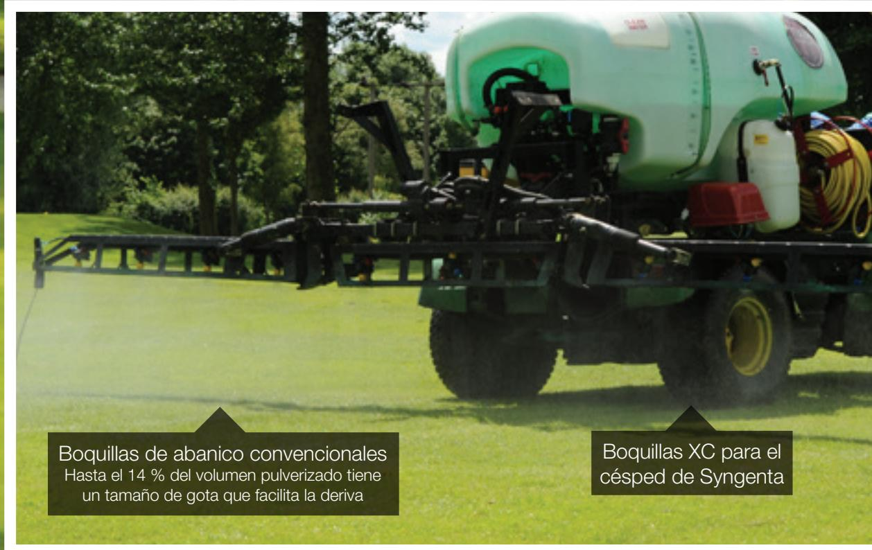
Las boquillas XC de Syngenta utilizan una innovadora tecnología de inducción de aire, que incorpora un colchón de aire en cada gota para reducir el riesgo de deriva y mejorar la retención de la pulverización sobre la hoja.
