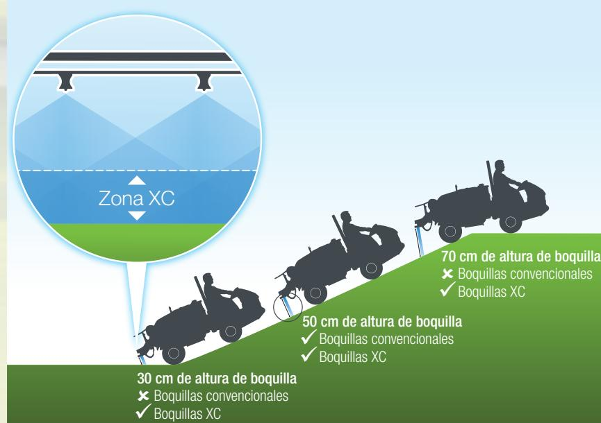
La boquilla XC para el césped de Syngenta se ha desarrollado con un concepto totalmente original y cuenta con una exclusiva forma de orificio que garantiza una cobertura uniforme, incluso cuando la altura de pulverización de la boquilla se reduce en un terreno ondulado.
